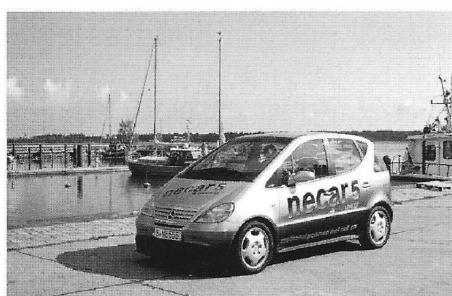
11.4. ábra. A DaimlerChrysler metanol üzemű, 2000-ben bevezetett NECAR 5 üzemanyagcellás járműve (a DaimlerChrysler hozzájárulásával)
